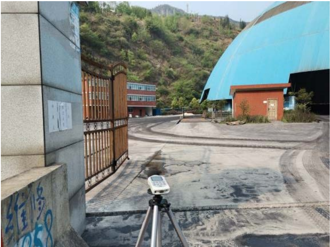
场地硬化、办公楼、堆场篷布遮盖及现场噪声监测图片
