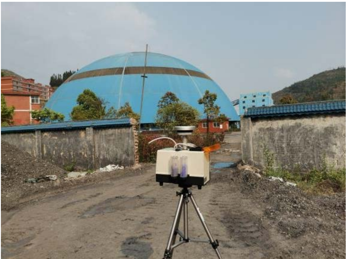
无组织废气现场采样图片
